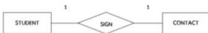
ภาพที่ 2.2 แสดงรูปแบบความสัมพันธ์แบบหนึ่งต่อหนึ่ง (One to One Relationships)
