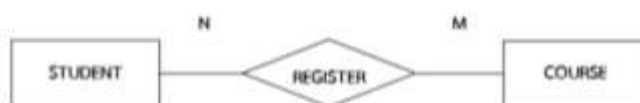
ภาพที่ 2.4 แสดงรูปแบบความสัมพันธ์แบบกลุ่มต่อกลุ่ม (Many to Many Relationships)
